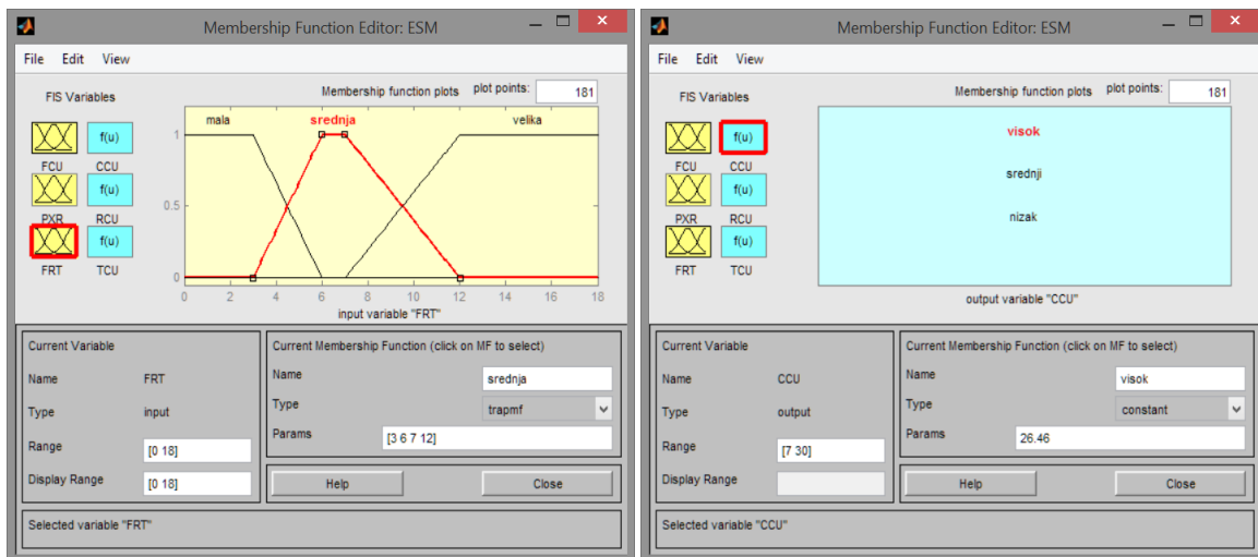
Slika 67. Definisane parametara funkcija pripadnosti u elementarnom Sugeno modelu (ESM): levo – potrošnja penušača (FRT); desno – sadržaj bakra u koncentratu (CCU).
