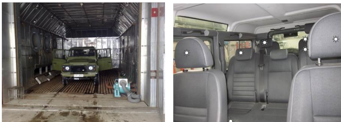
Слика 8.4.3.1. – Приказ возила у хладној комори и мерних места у кабини
