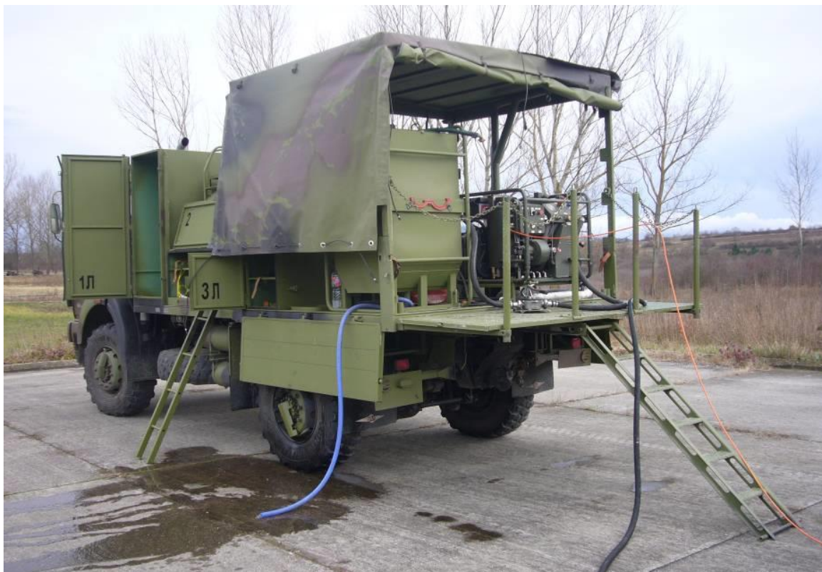
Слика 6.23. – ТА ФАП 1118 БС/А са платформом за деконтаминацију
