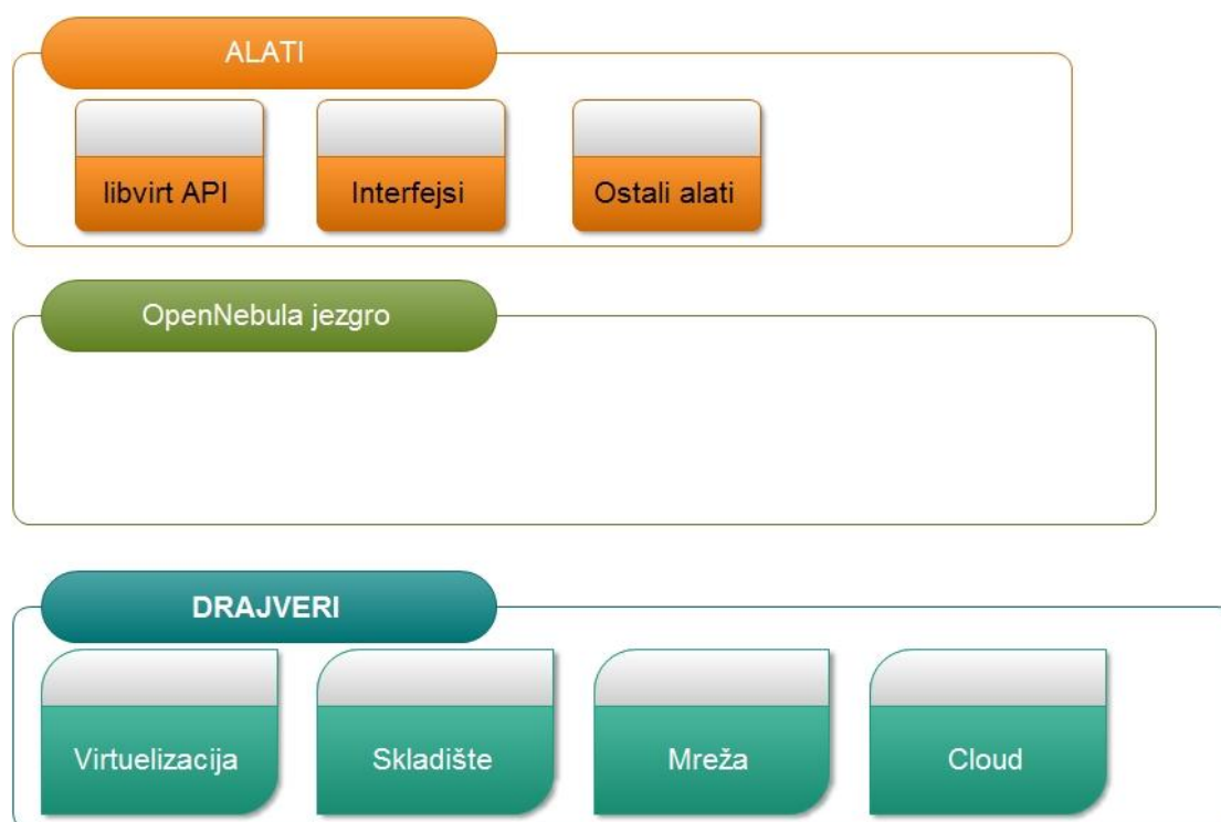
Slika 3.8 - Arhitektura OpenNebula platforme
