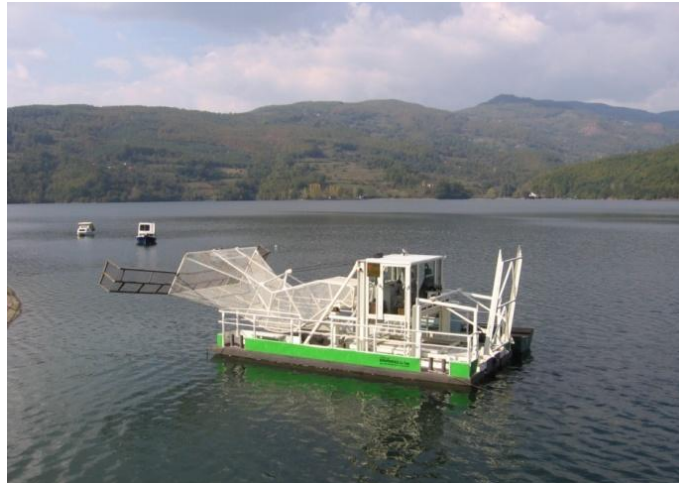
Сл. 64. Водочистач на језеру Перућац (фото: "Дринско-Лимске ХЕ")
