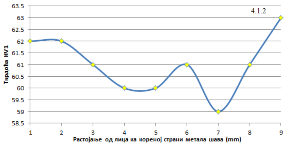
Слика 5.13 Расподела и места мерења микротврдоће кроз пресек споја 4.1 а) узорак 4.1.1 и б) узорак 4.1.2
