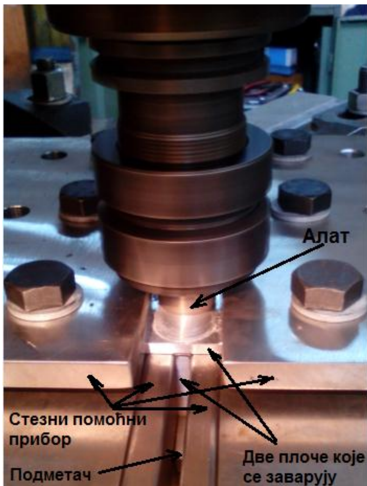
Слика 4.2 Фотографија позиције алата, стезног помоћног прибора и радних плоча током процеса заваривања
