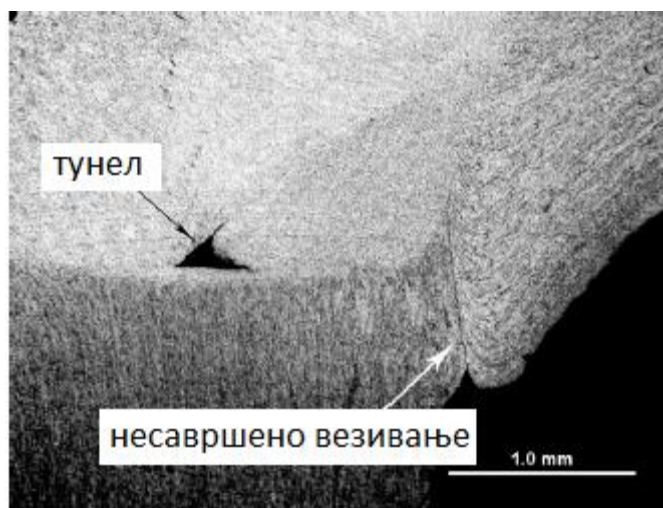
Слика 2.18 Микроскопски приказ грешке типа тунела и непровареног корена код Т-споја [31]
