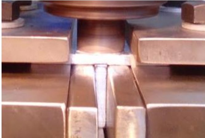
Слика 5.2 Продирање трна алата у материјал радних плоча, проба 3.1
