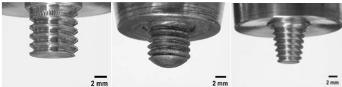
Слика 2.27 Фотографије: а) цилиндрични трн са равним врхом, б) цилиндрични трн са куполом на врху и в) трн конусног облика са равним врхом [22]
