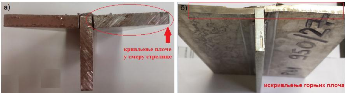
Слика 5.9 Примери искривљења споја код: а) легуре 5052-Н32, проба 3 и б) легуре 5753-Н111, проба 4.1
