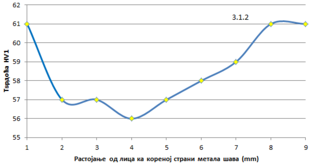
Слика 5.12 Расподела и места мерења микротврдоће кроз пресек spoja 3.1 а) узорак 3.1.1 и б) узорак 3.1.2
