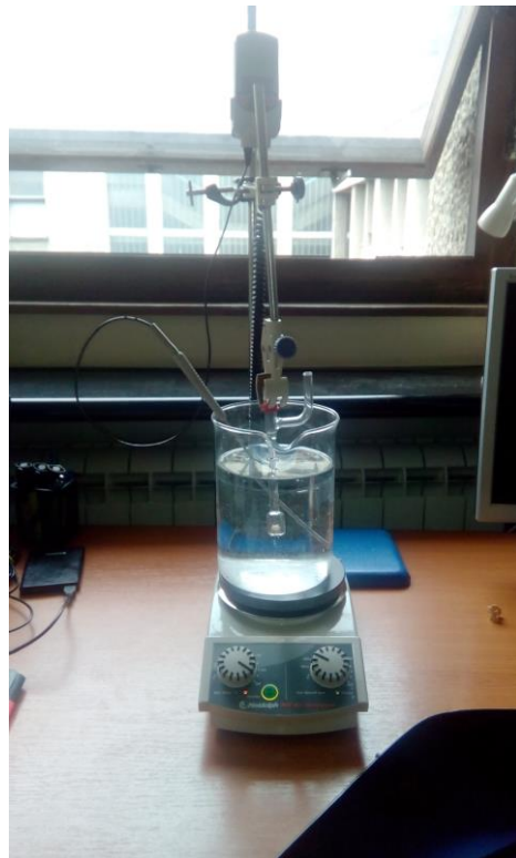
Slika 3.12 Aparatura za merenje ravnoteže tečno – tečno (LLE)
