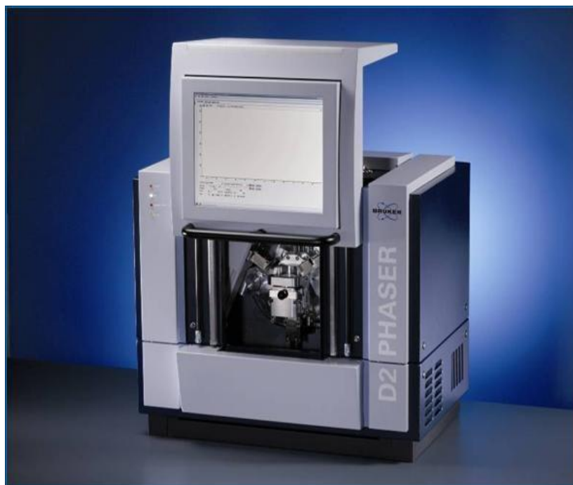
Slika 4.2. XRD uređaj model D2 PHASER firme Bruker.
