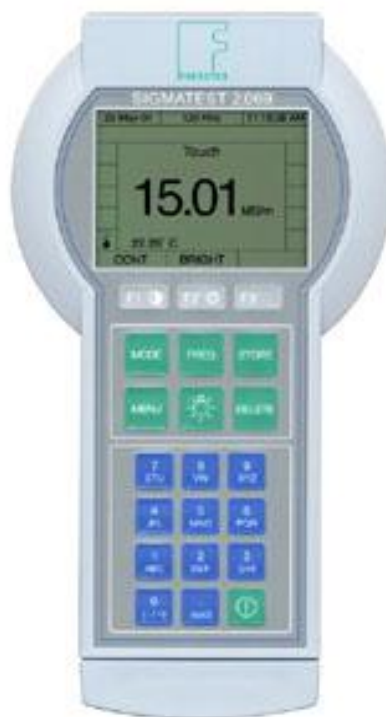
Slika 4.7. Uređaj za merenje elektroprovodljivosti, model SIGMATEST 2,069.
