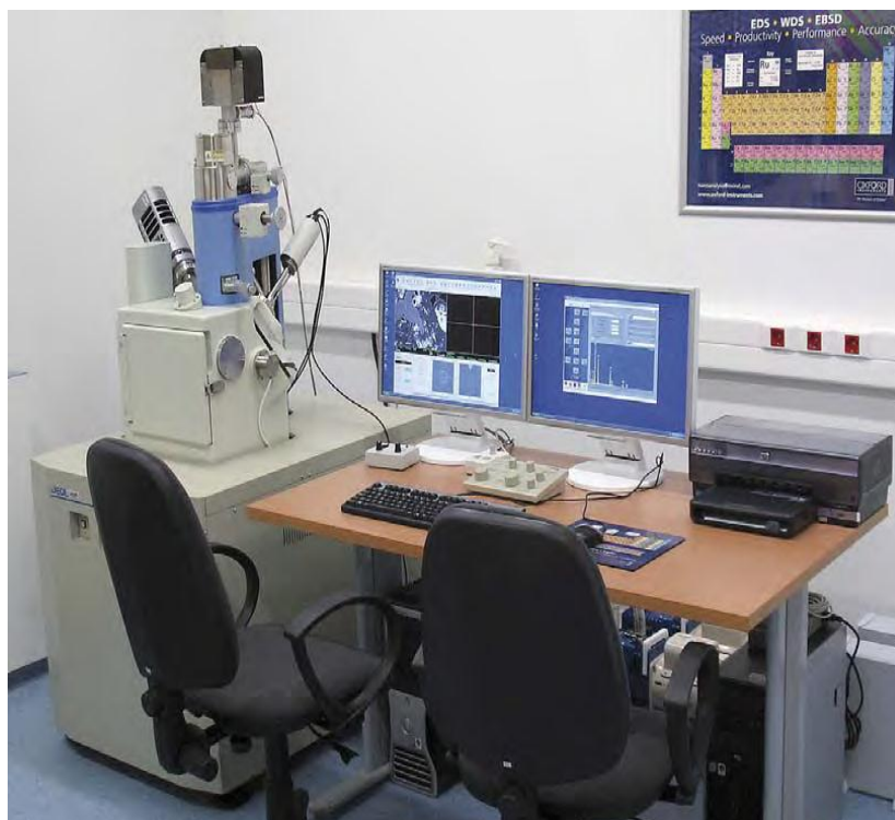
Slika 4.3. Skenirajući elektronski mikroskop model JEOL JSM-6460.
