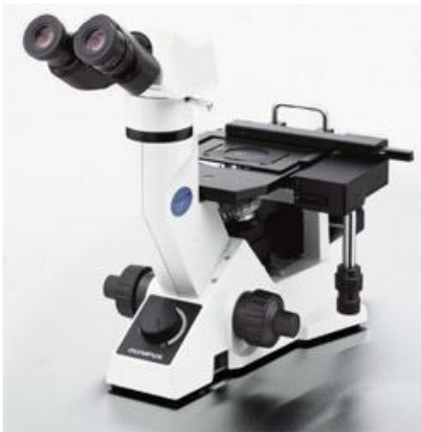
Slika 4.4. Invertni optički mikroskop model OLYMPUS GX41.
