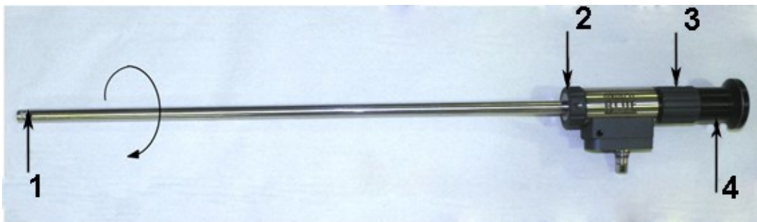
Slika 26. Boroskop za snimanje (1-90°C ogledalo, 2-prsten za podešavanje vidnog polja, 3-prsten za podešavanje fokusa, 4-konektor za kameru) (autor: Institute for Corrosion and Multiphase Technology, Ohio).
