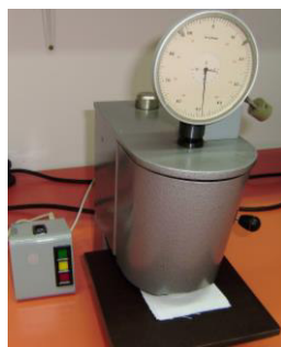
Slika 41. Debljinomer Karl Schröder DM 100
