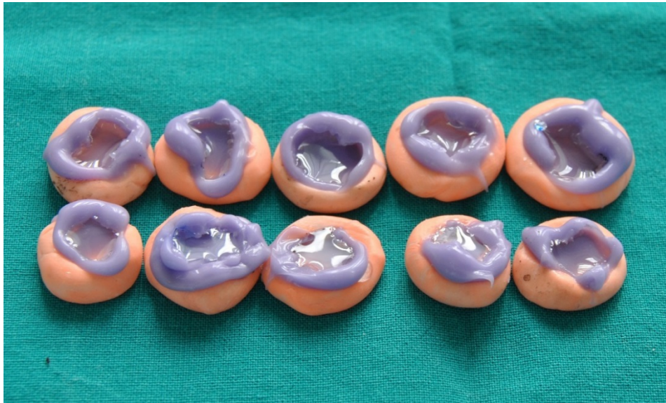
Slika 21. Epoksi smola ulivena u otisnu masu polivinilsiloksana
