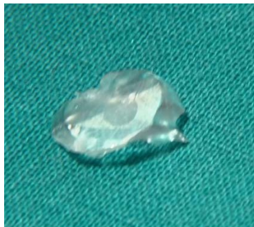
Slika 22. Epoksi replika odvojena od otisnog materijala
