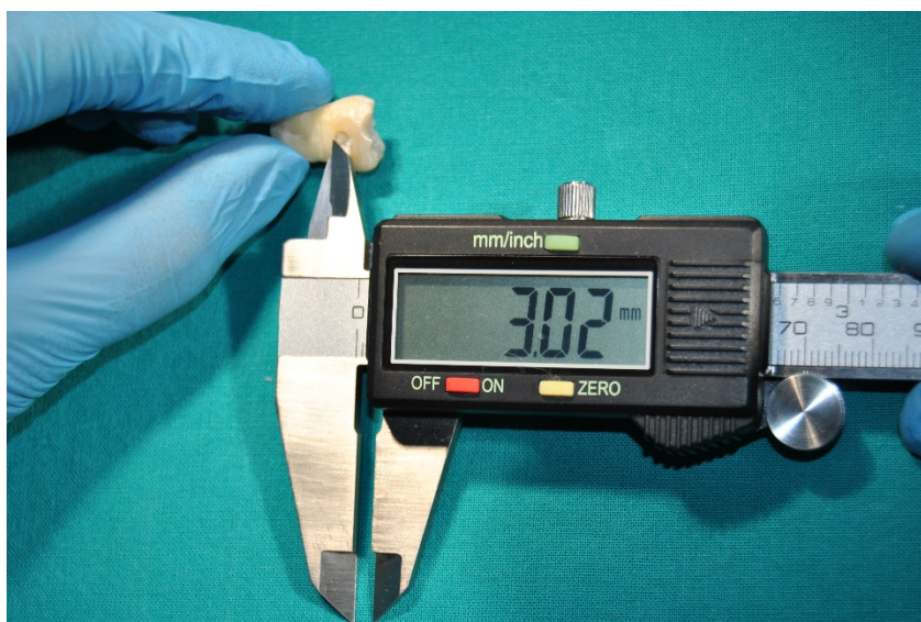
Slika 12. Provera dijametra kaviteta digitalnim kaliperom
