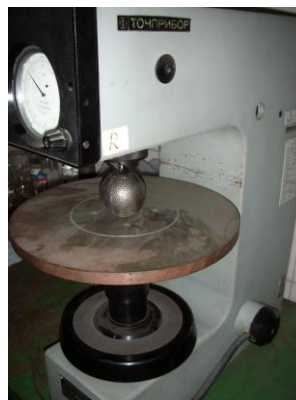
Слика 7.7 Мерење тврдоће узоркованих кугли методом Rockwel „C“ [112]
