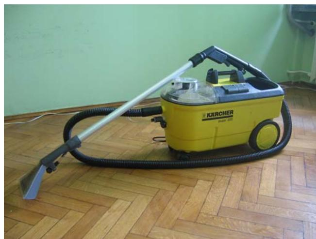
**Slika 12.** Usisivač za čišćenje dubinskom ekstrakcijom (Puzzi 200, Karcher), korišćen za tretiranje koža ispiranjem sanitajzerom i vakumiranjem
