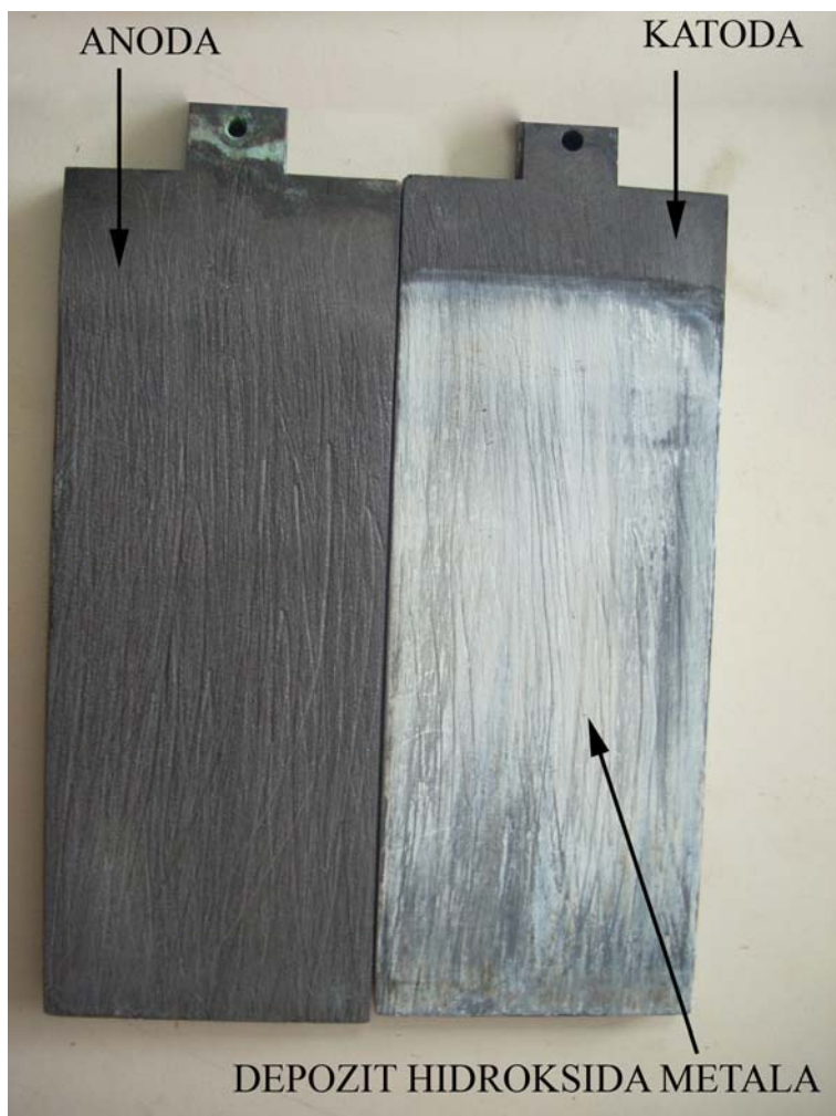
Slika I. Izgled grafitnih elektroda nakon EK tretmana
