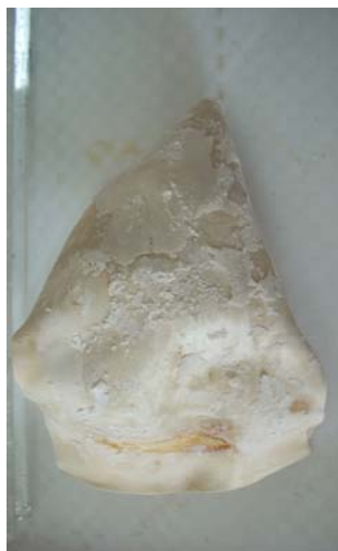
Slika III. Izgled CEM (Ralex CM-PAD) pre i nakon 7 dana elektrodijalitičkog tretmana (nakon sušenja membrana gubi prvobitni oblik)
