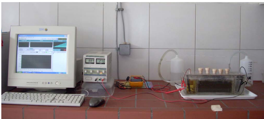
Slika II. Izgled uređaja za elektrokinetičku remedijaciju
