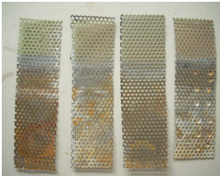
Slika IV. Izgled bipolarnih elektroda (čelične pločice) nakon EK tretmana
