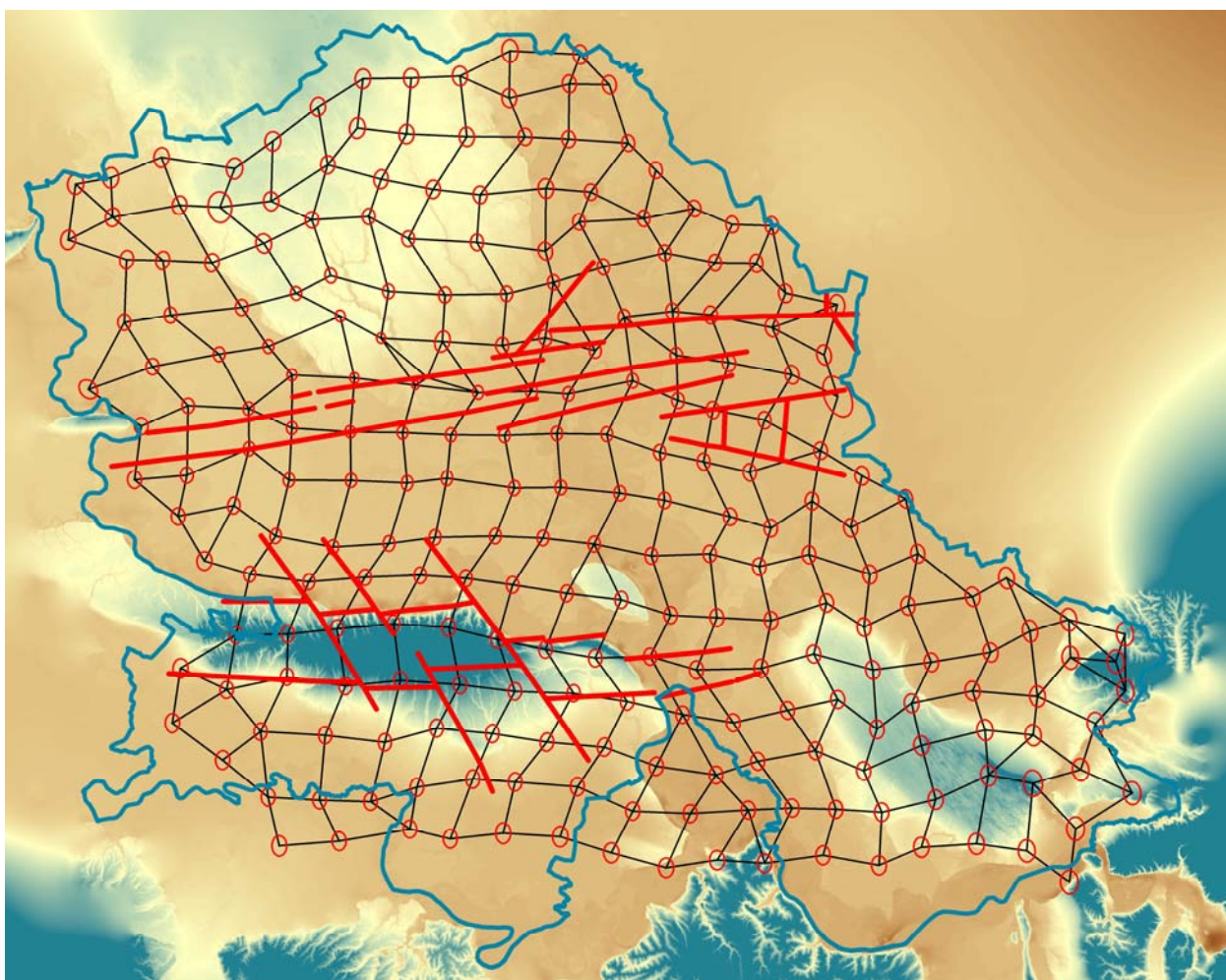
Slika 7.3. Dispozicija tačaka formiranog deformacionog geodinamičkog modela pasivne referentne mreže, sa geološkim pozicioniranjem većih raseda na predmetnoj oblasti istraživanja (sa generisanim digitalnim modelom terena)
