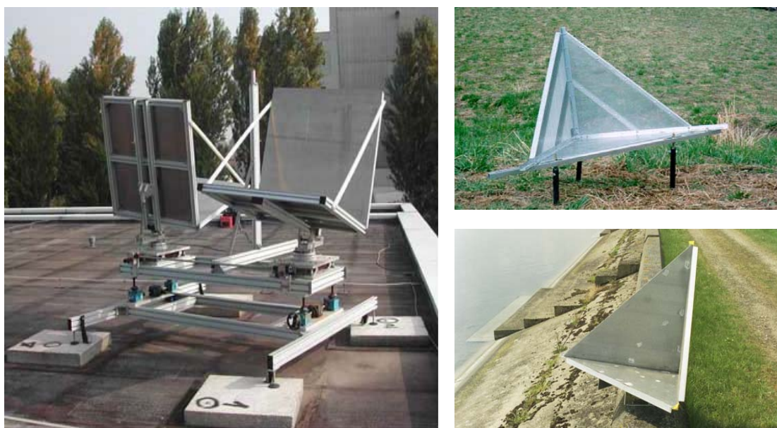
Slika 3.5. Različite vrste veštačkih PSInSAR reflektora, mobilni reflektor (levo) i ugaoni reflektori (desno)
