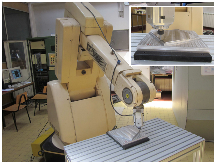
Слика 6.9: Обрада контуре заротираног квадрата на тест радном делу на роботу ЛОЛА50
