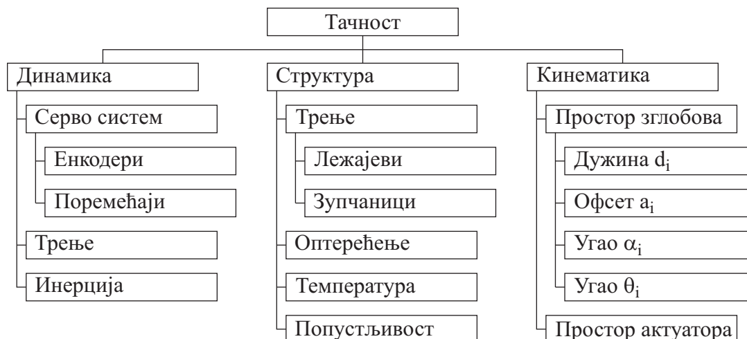
Слика 3.2: Структура грешака које утичу на тачност и поновљивост робота [71]
