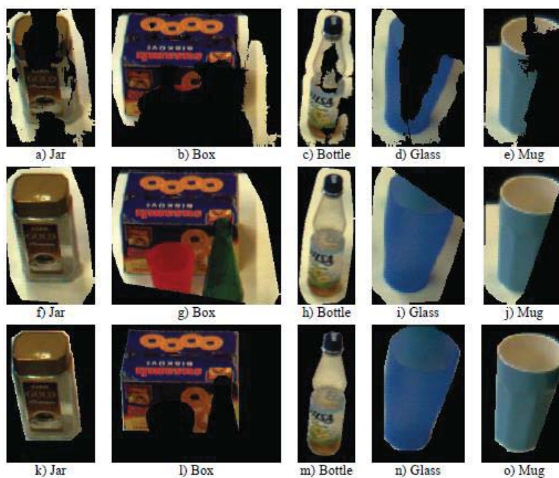
Slika 3.14 Segmentacija mape dispariteta, konveksno popunjavanje okvira i ručno segmentirani objekti[47]
