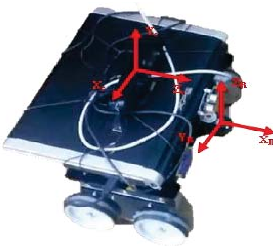
Slika 7.8. DaNI robot opremljen laptopom i Asus Xtion PRO LIVE kamerom i njihovi koordinatni sistemi
