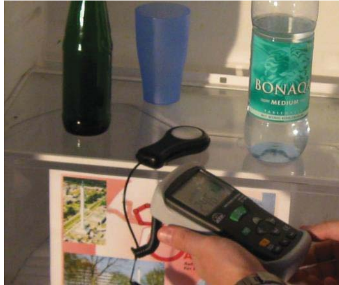
Slika 4.13 Merenje osvetljenja scene
