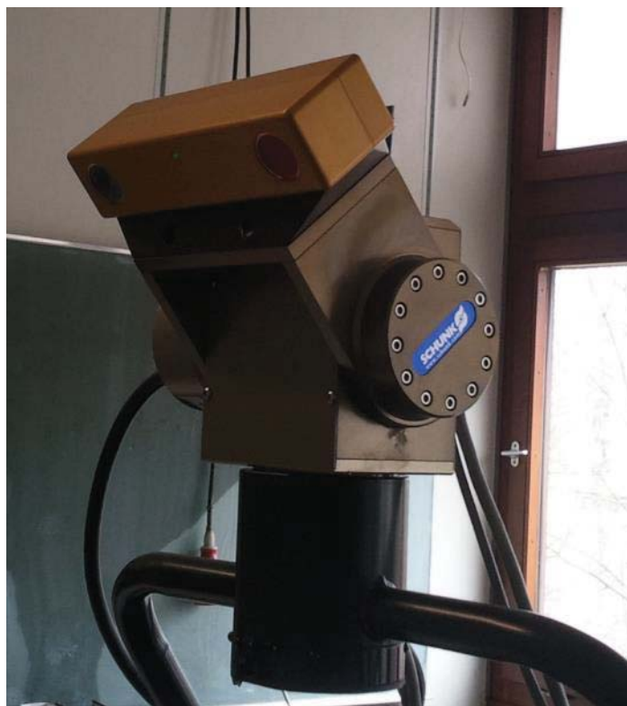
Slika 4.9 Bumblebee® 2 stereo kamera i upravljivo postolje sa 2 stepena slobode kretanja
