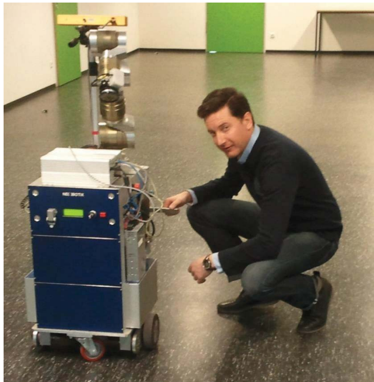
Slika 5.3 Testiranje upravljačkih algoritama mobilne robotske platforme sa stereo kamerom za praćenje ljudi
