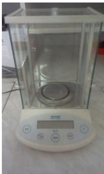
Slika 2. Vagica za merenje mase uzoraka materijala
