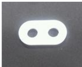
Slika 1. Kalup za pripremu uzoraka materijala
