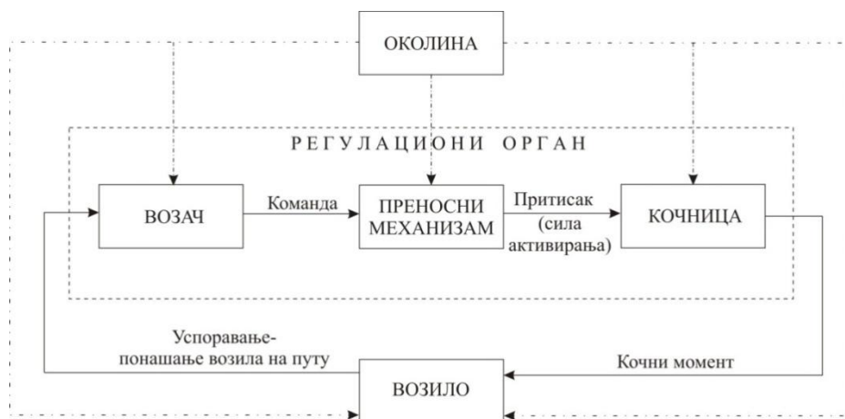
Слика 4.1. Функционални модел процеса кочења [24]
