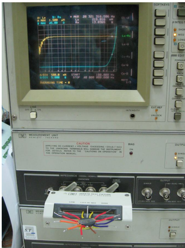
Slika 3.15. Inicijalna testiranja električnih parametara uzoraka sa montiranim feritnim jezgrom na impedansnom analizatoru HP4194A
