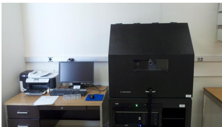
Slika B.1. Uobičajena konfiguracija nanoindentera Agilent G-200
