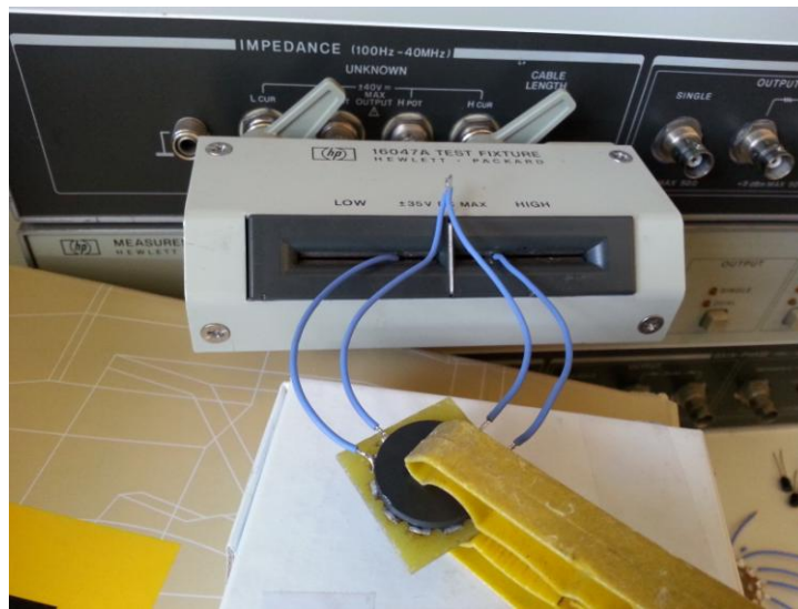
Slika 4.4. Merenje koeficijenta sprege između faznih induktora rednim vezivanjem faznih namotaja
