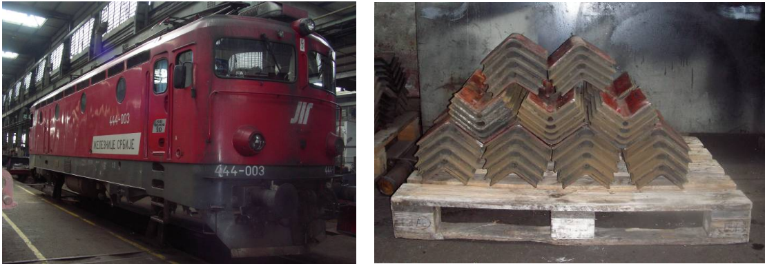
Слика 5.20. Детаљи са демонтаже испитних гумено-металних елемената у МИН Локомотива, мај 2013. године
