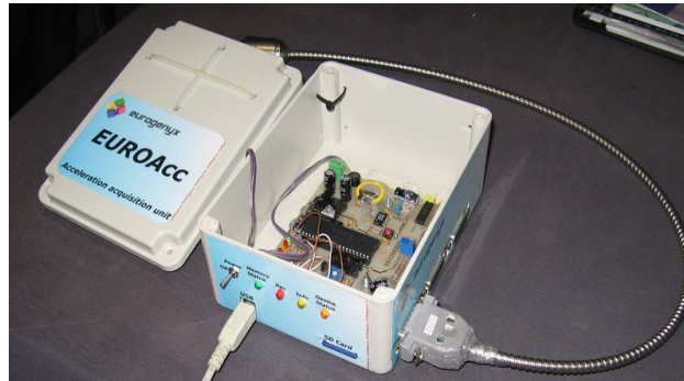
Слика 5.3. Уређај EUROACC развијен на Машином факултету у Нишу за експериментално испитивање динамичких карактеристика железничких возила [162]
