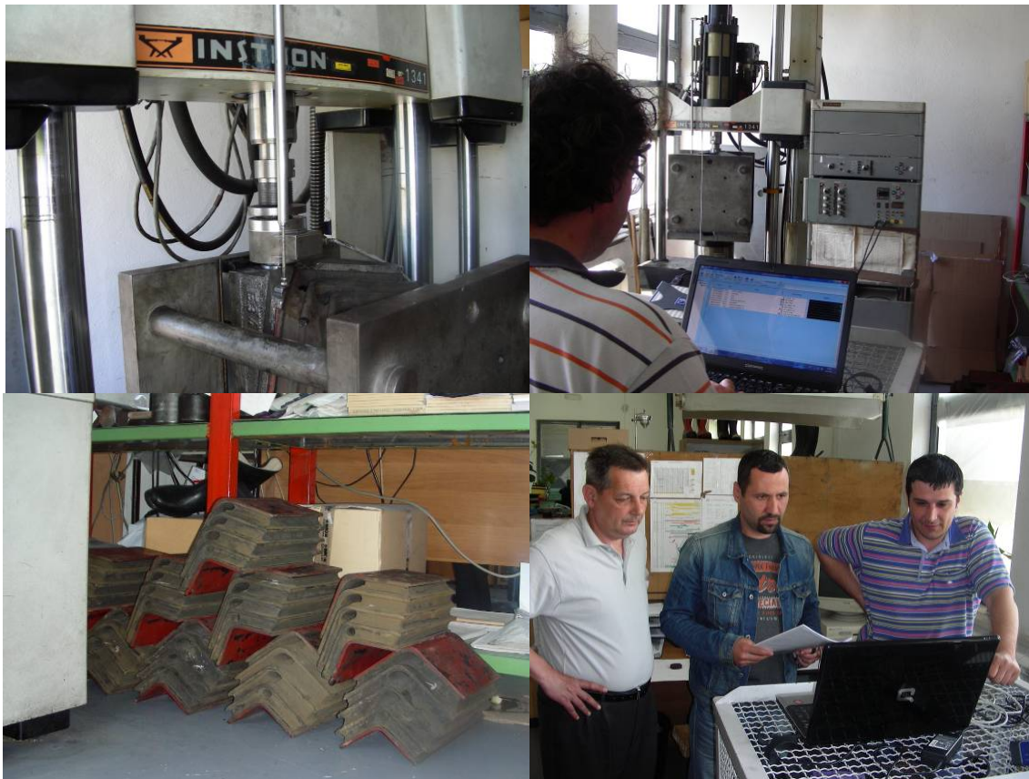
Слика 5.21. Детаљи са испитивања статичке крутости појединачних гумено-металних елемената у ТИГАР Техничка гума, 21. и 22. мај 2013. године
