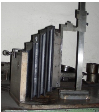
Слика 5.11. Мерно место за проверу геометријских мера гумено-металних елемената
