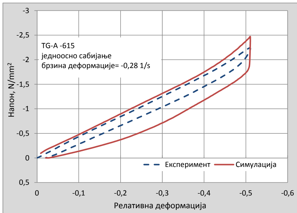
Слика 3.22. Поређење механичког одзива добијеног експерименталним путем и симулацијом применом Бергстром-Бојс модела за смешу TG – A – 615 при две брзине деформације
