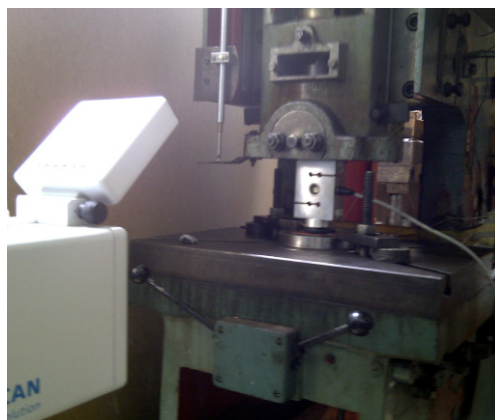
Слика 4.29. Мерно место за верификацију процедуре процене генерисања топлоте
