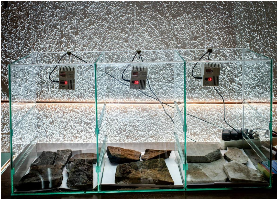
Слика 5.1. Изглед конструисане апаратуре за одређивање екshalације
