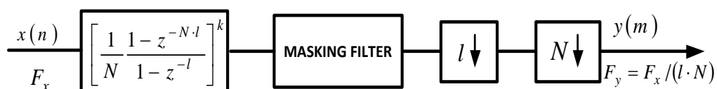
Слика 6.38 CIC дециматор реализован техником фреквенцијског маскирања
