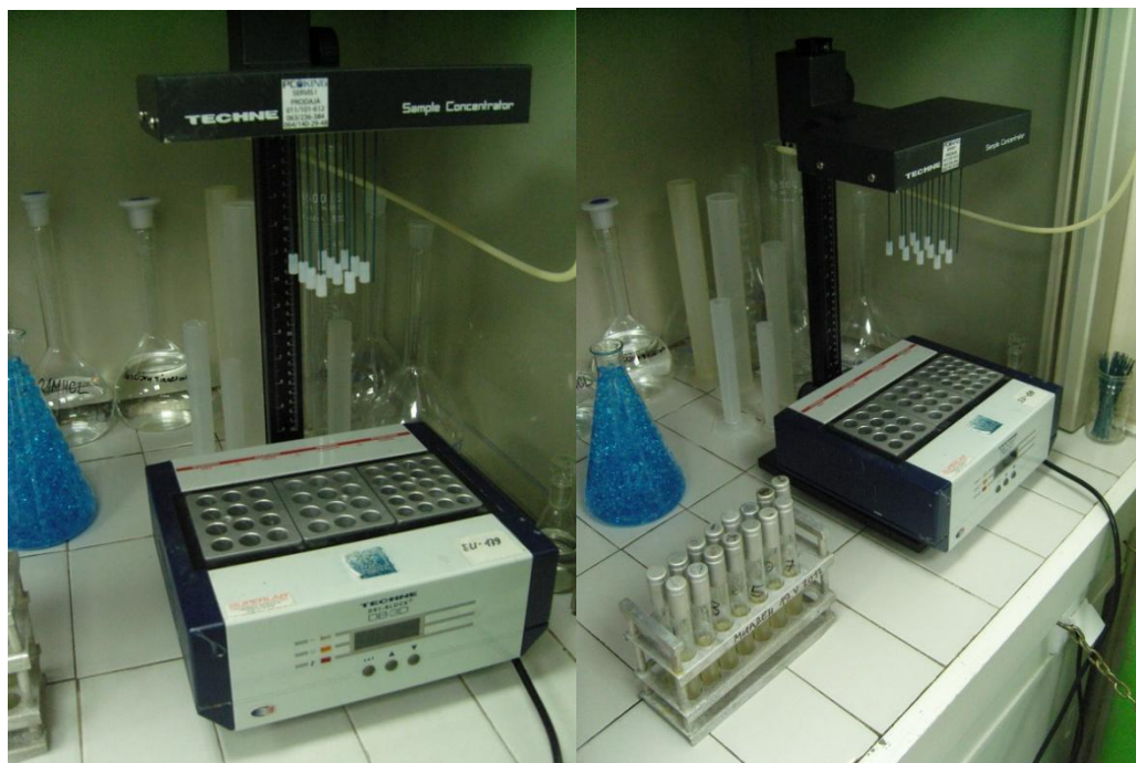
Слика 8. Деструктор (Techne, Dri Block DB 3D)
