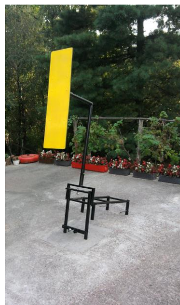
Slika 9. Sprava za merenje vertikalnog iskoka iz vode
