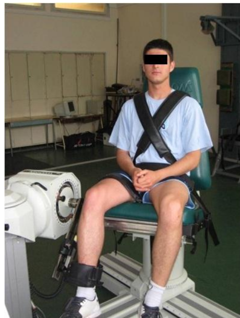
Slika 4. Položaj ispitanika prilikom izvođenja testova na izokinetičkom dinamometru
