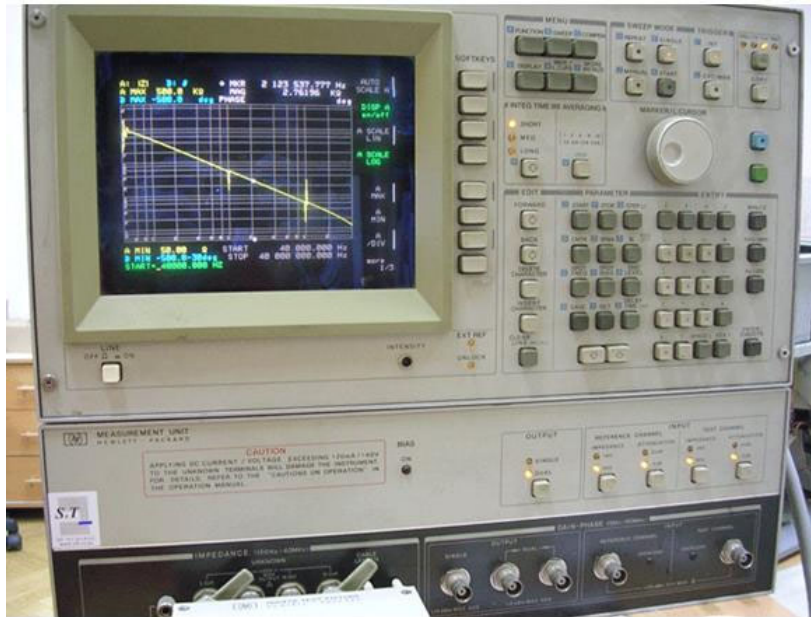
Slika 5.9. Instrument za merenje provodnosti u AC režimu
