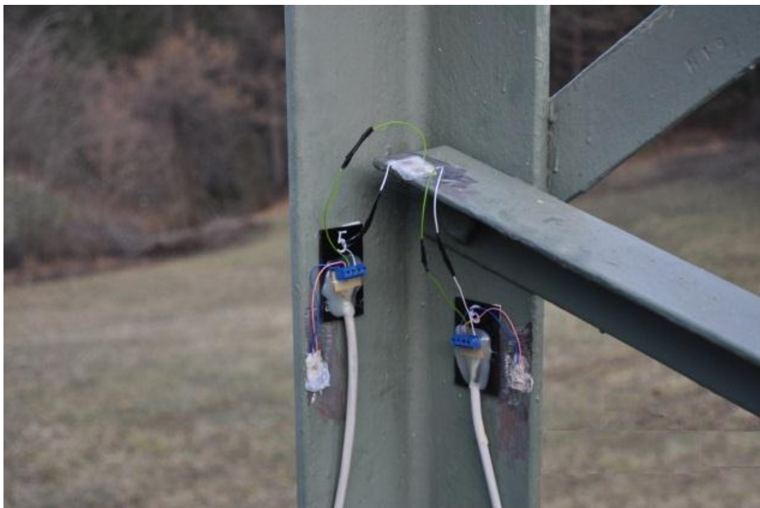
Slika 4.4. Pozicija mernih traka "5" i "6" povezanih na akvizicioni sistem
