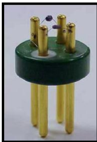
Slika 3.3.1. Katalitički senzor za merenje zapaljivih gasova sa perlom (preuzeto iz [59])
