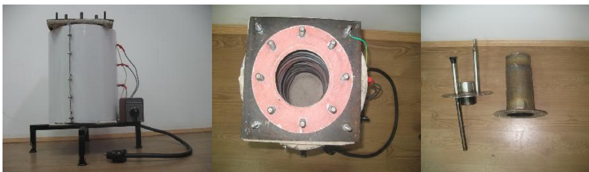
Slika 5.7. Fotografski izgled električne peći i reaktorske posude
