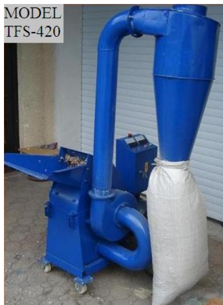
Slika 5.1. Mlin za drvni otpad i biomasu TFS-420, proizvo a Termis MKM doo, Knjaževac
