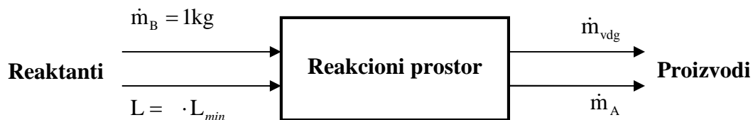
Slika 4.20. Šematski prikaz materijalnog bilansa procesa sagorevanja drvene biomase
