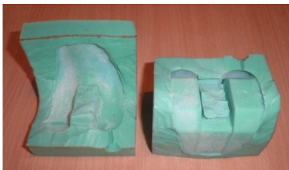
Slika 6.78. Rastavljen kalup od silikonske gume za izradu voštanog modela implantata kolena
