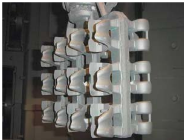
Slika 4.11. Odlivci implantata kolena izrađeni livenjem u vakuumu
