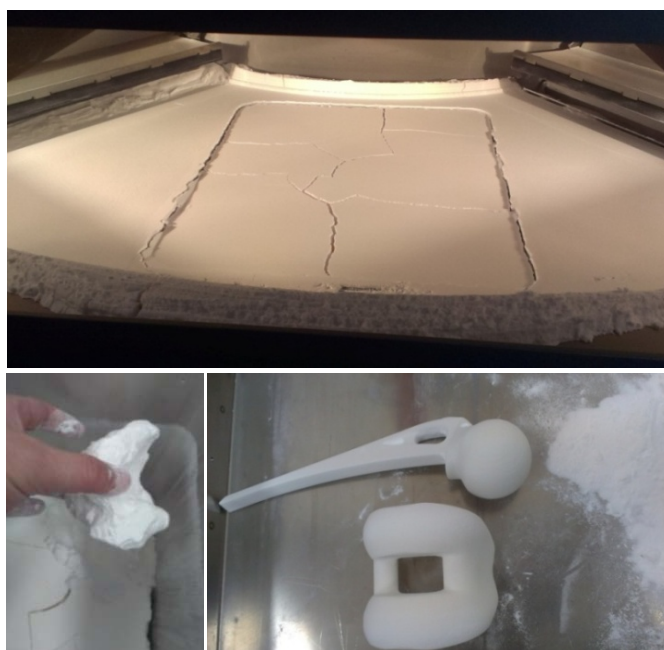
Slika 6.60. Različite faze štampanja SLS modela implantata kolena i kuka
