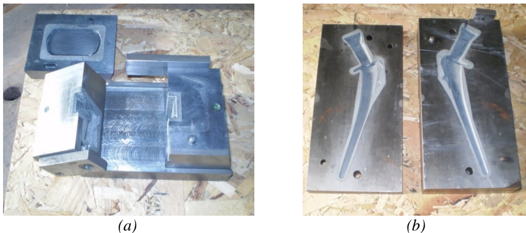
Slika 4.5. Alati za izradu topljivih modela komponenti implantata kolena (a) i kuka (b)
