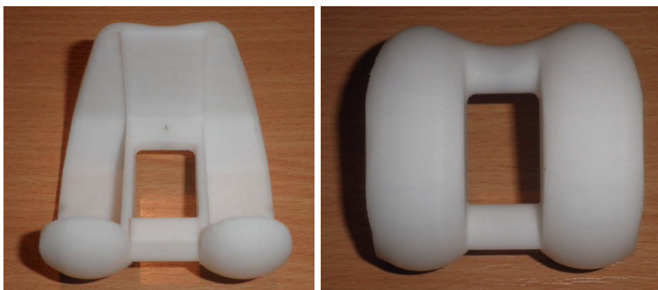
Slika 6.72. Završni FDM model implantata kolena
