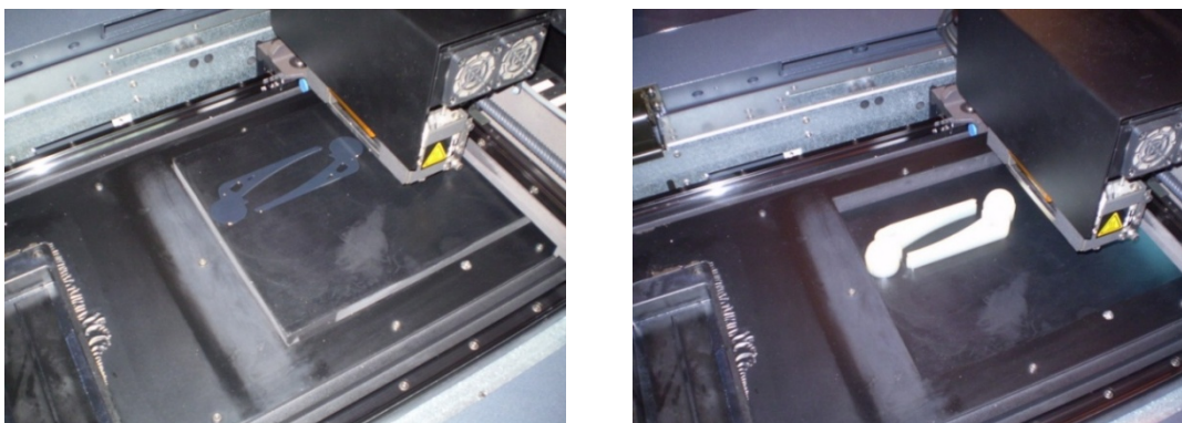
Slika 6.56. Različite faze štampanja PolyJet implantata kuka
