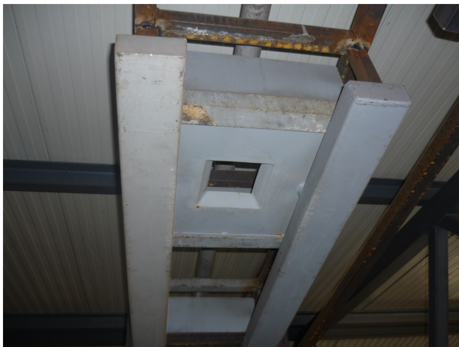
Prilog 47. Kutija za ograničavanje dometa mlaza i oluci za povrat viška vode iz kutije u rezervoar
