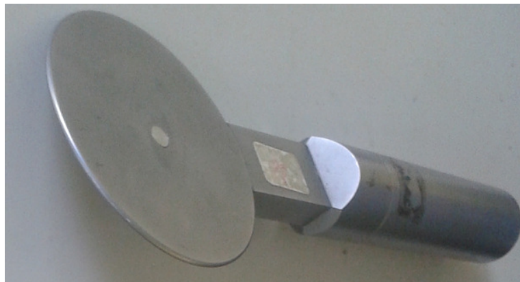
Слика 7.4 Пиезоелектрични сензор за мерење натпритиска РСВ В5
