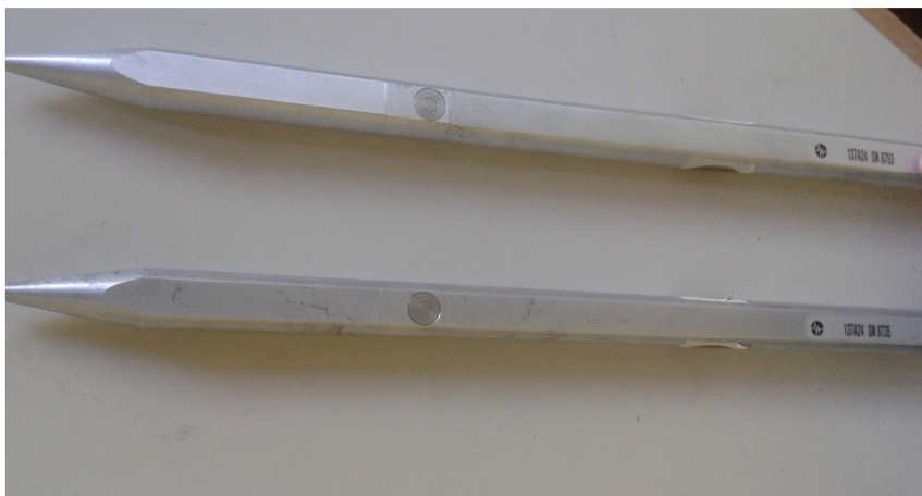
Слика 7.5 Пиезоелектрични сензор за мерење натпритиска РСВ 137
