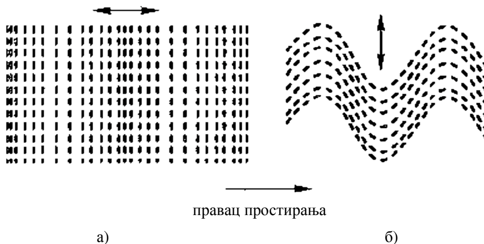
Слика 2.1 Простирање звучних таласа: а-лонгитудинални таласи, б-трансферзални таласи
