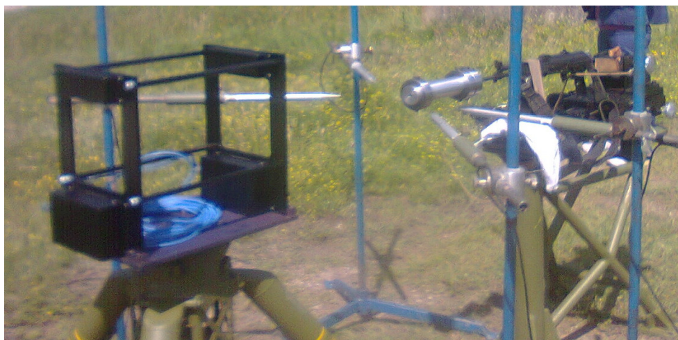
Слика 7.11 Мерења почетне брзине пројектила фотоћелијском баријером
