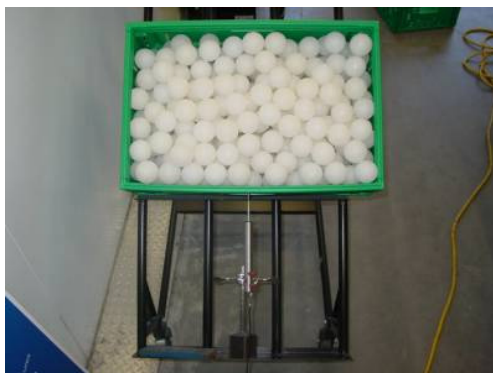
Слика 7.16. Мерење бочне деформације странице
