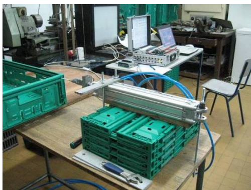
Слика 7.30. Развијени динамометар за мерење силе отварања страница
