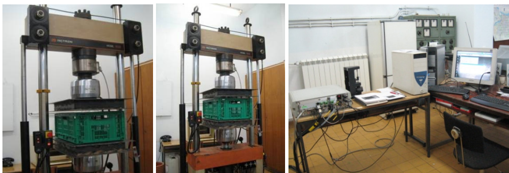
Слика 7.9. Хидрауличка кидалица од 10т ИНСТРОН (Технолошко-металуршки факултет, Београд).
