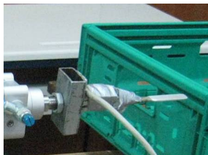
Слика 7.30. Развијени динамометар за мерење силе отварања страница
