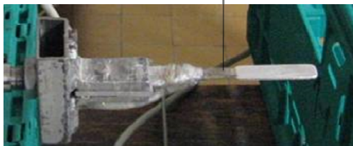
Слика 7.30. Развијени динамометар за мерење силе отварања страница
