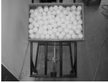
Слика 3.6. Испитивање деформације дуже странице
