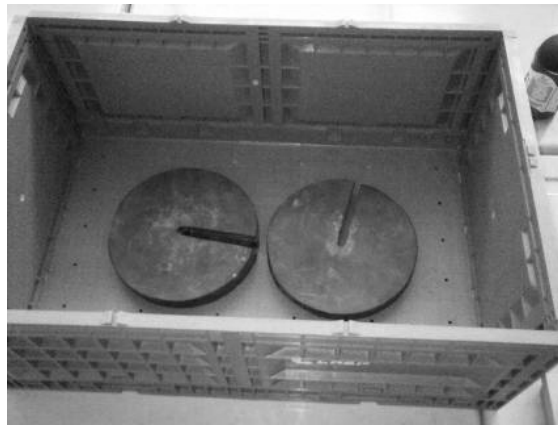
Слика 7.14. Мерење деформације база са оловним теговима
