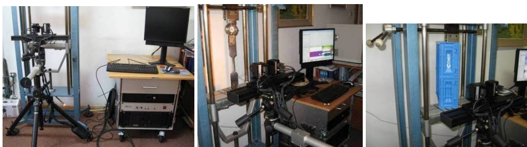
Слика 7.6. GOM хардвер и софтвере АРАМИС [48]
