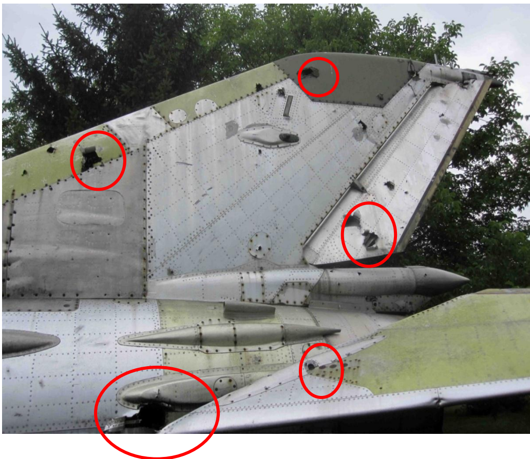
Слика 2 - Оштећење ваздухопловних структура ватреним пројектилом
