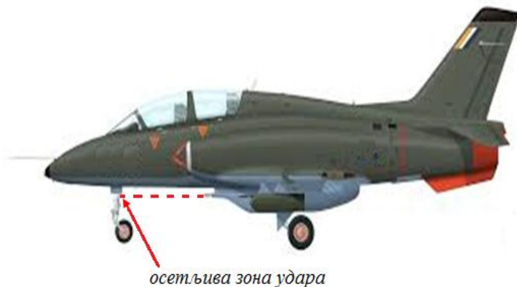
Слика 66. Ваздухоплов са подвешеним контејнером топа
