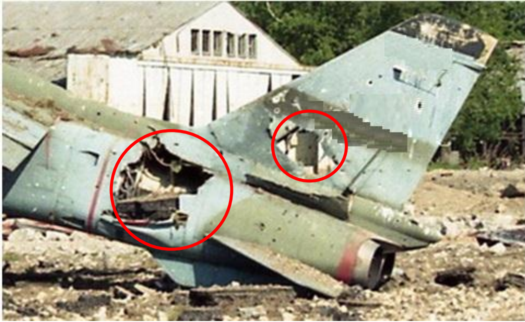
Слика 1- Оштећење ваздухопловних структура гелерима авио-бомбе
