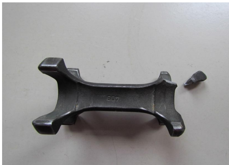
Слика 74. Поломљени звездасти сепаратор
