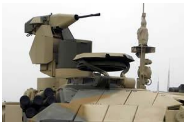
Слика 1.6: Нови панорамски нишан командира, даљински управљана борбена станица са митраљезом 7,62 mm и активно-реактивни оклоп на бочној страни куполе тенка Т-90
