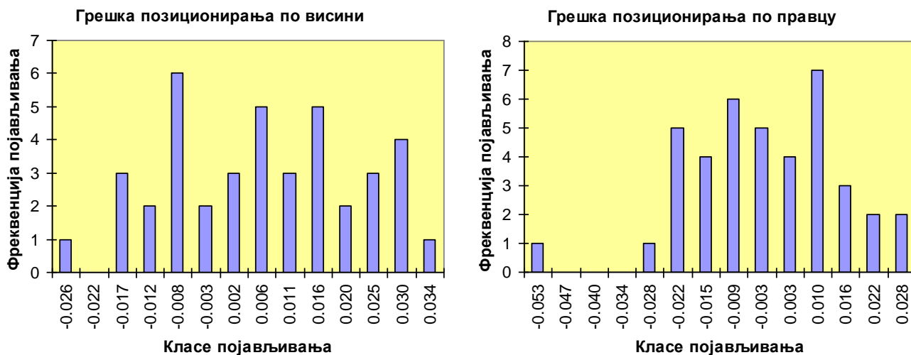
Слика 7.9: Нормална расподела грешака позиционирања по висини и по правцу при симулацији гађања на 2800 m
