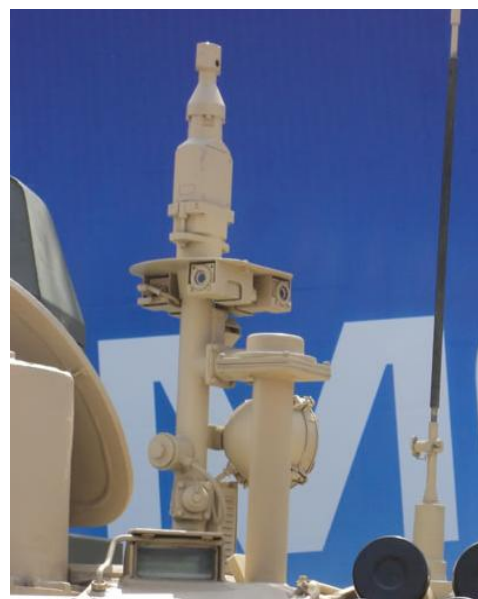
Слика 1.7: Четири видео-камере за осматрање, у опсегу од 360°, и метео-сензор тенка Т-90
