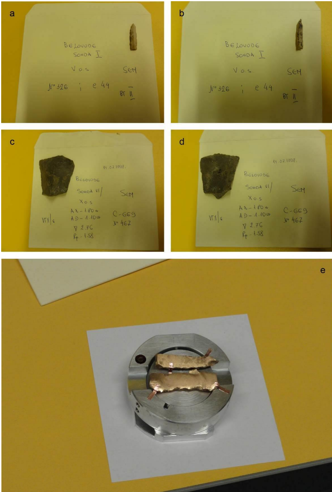
Sl. 149. Belovode/Vinča Tordoš II: izbor artefkata i priprema za SEM analize: a-d) uzorci pre snimanja; d) prevlačenje uzoraka zlatnim oksidom i fiksiranje na podlogu - priprema za SEM snimanje.
