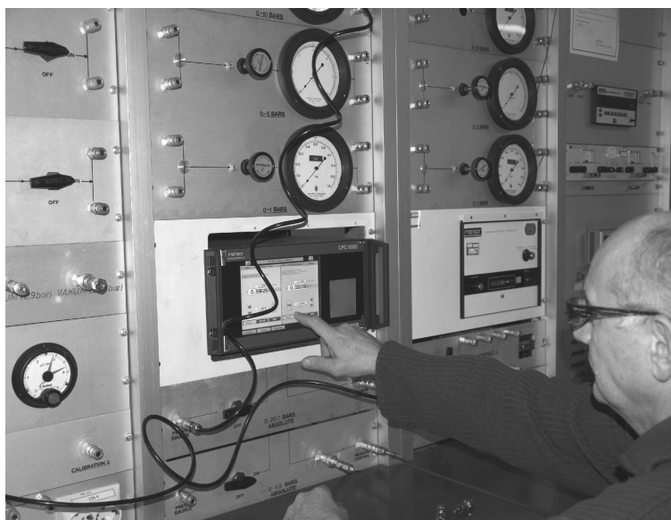
Sl. 55. Kalibrator pritiska Mensor CPC 6000 integrisan u laboratoriji za pritiske VTI-a
