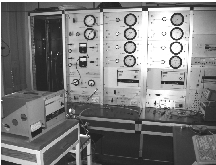
Sl. 53. Mensor QM/C kontroleri pritiska, laboratorija za pritiske, T-38
