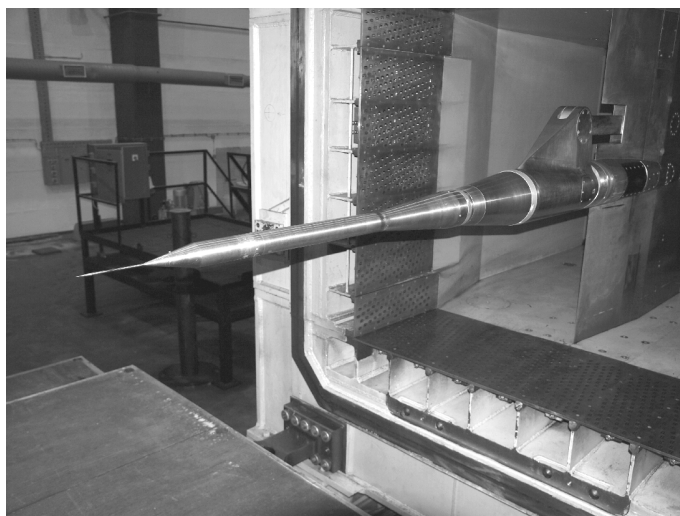
Sl. 63. Konus-cilindar sonda za merenje statičkog pritiska na držaču opšte namene
