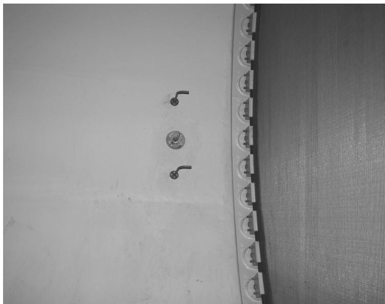
Sl. 49. Pito-sonde i temperaturna sonda u komori umirenja aerotunela T-38
