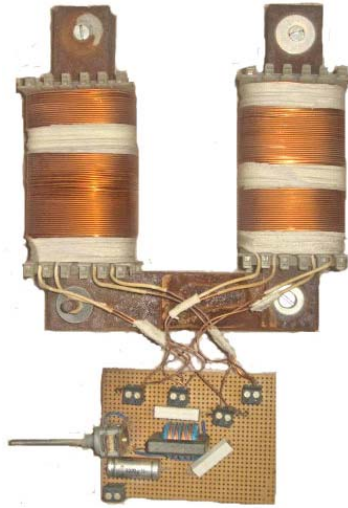
Сл. 3.19. Фотографија конструисаног дистантног струјног електромагнетног давача
