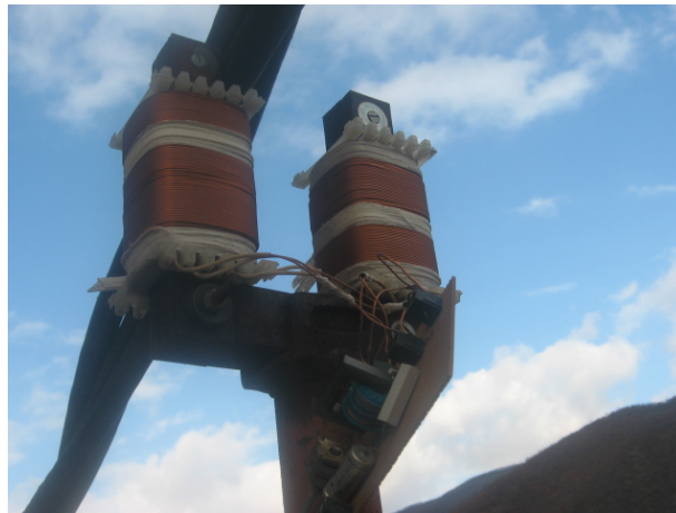
Сл. 3.20. Изглед конструисаног струјног електромагнетног давача и места где је постављен
