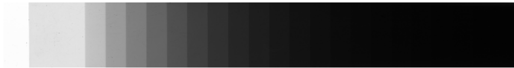
Slika 2. „Kodak“ step tablet za kalibraciju optičke gustine ImageJ sistema
