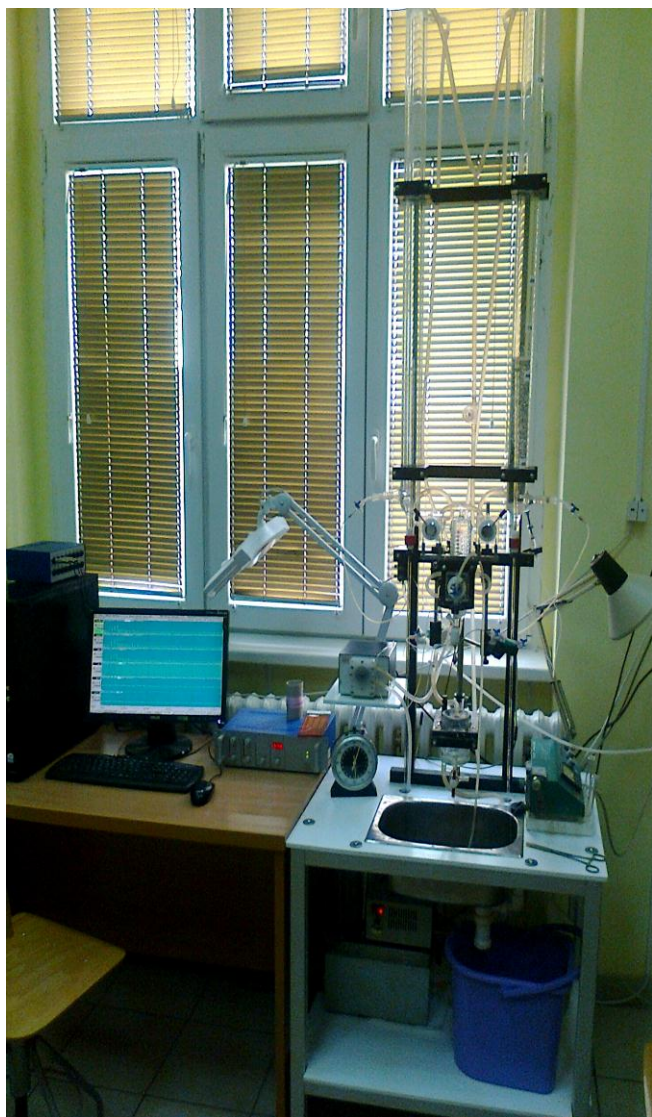
Слика 1. Модификовани апарат по Langendorff -у
