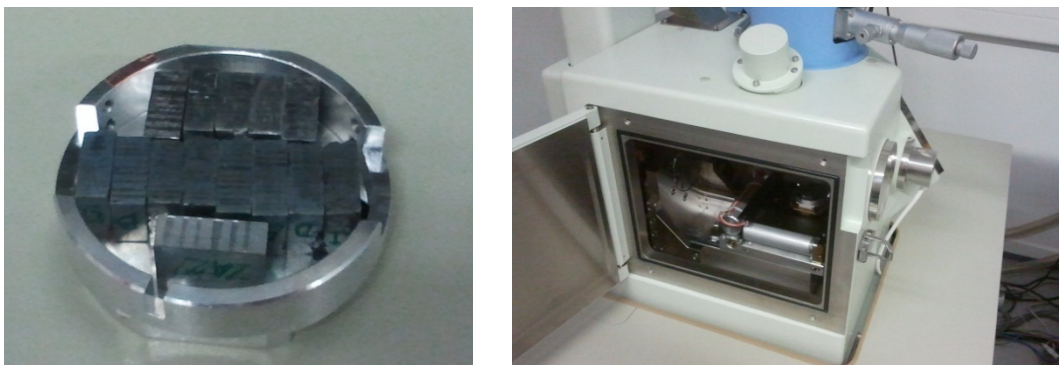
Слика 5.20. Узорци за испитивање на носачу и у СЕМ микроскопу
