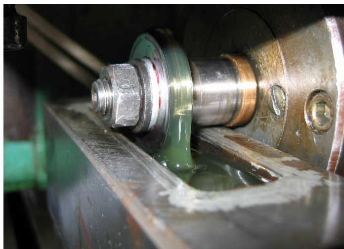
Слика 6.26. Подмазивање контактнег пара
