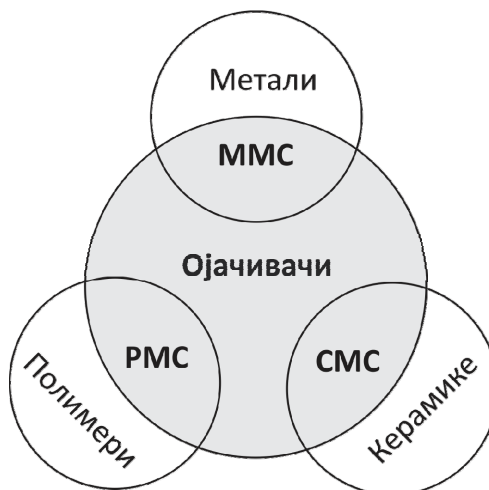
Слика 2.1. Подела композита
