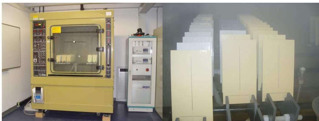
Слика 3. Процес излагања металних плоча које садрже заштитне слојеве (Извор: А. Јовановић et al., 2012, Final report for FP7 MUST project)
