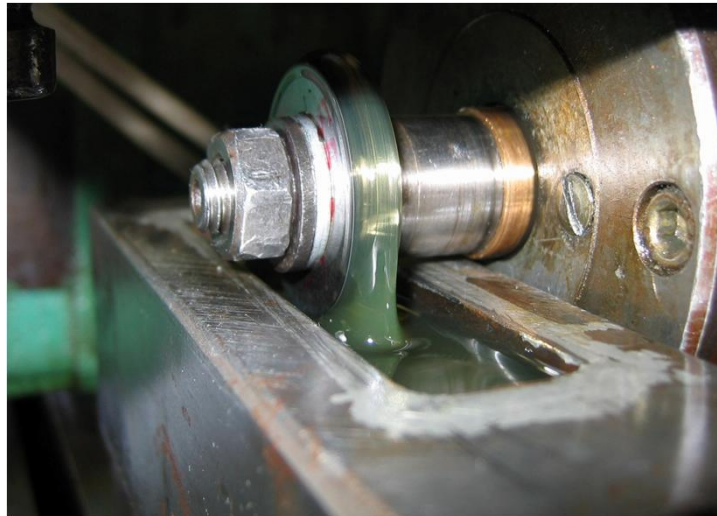
Слика 4.32 Подмазивање контактног пара
