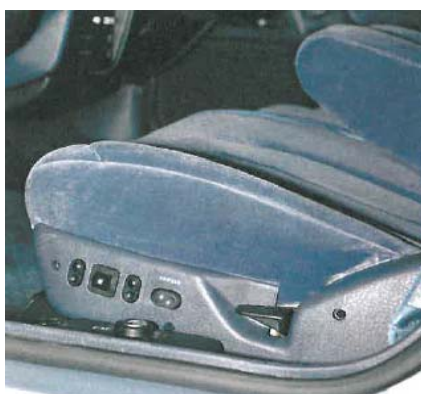
Слика 3.9 Механизам за померање седишта у возилима
