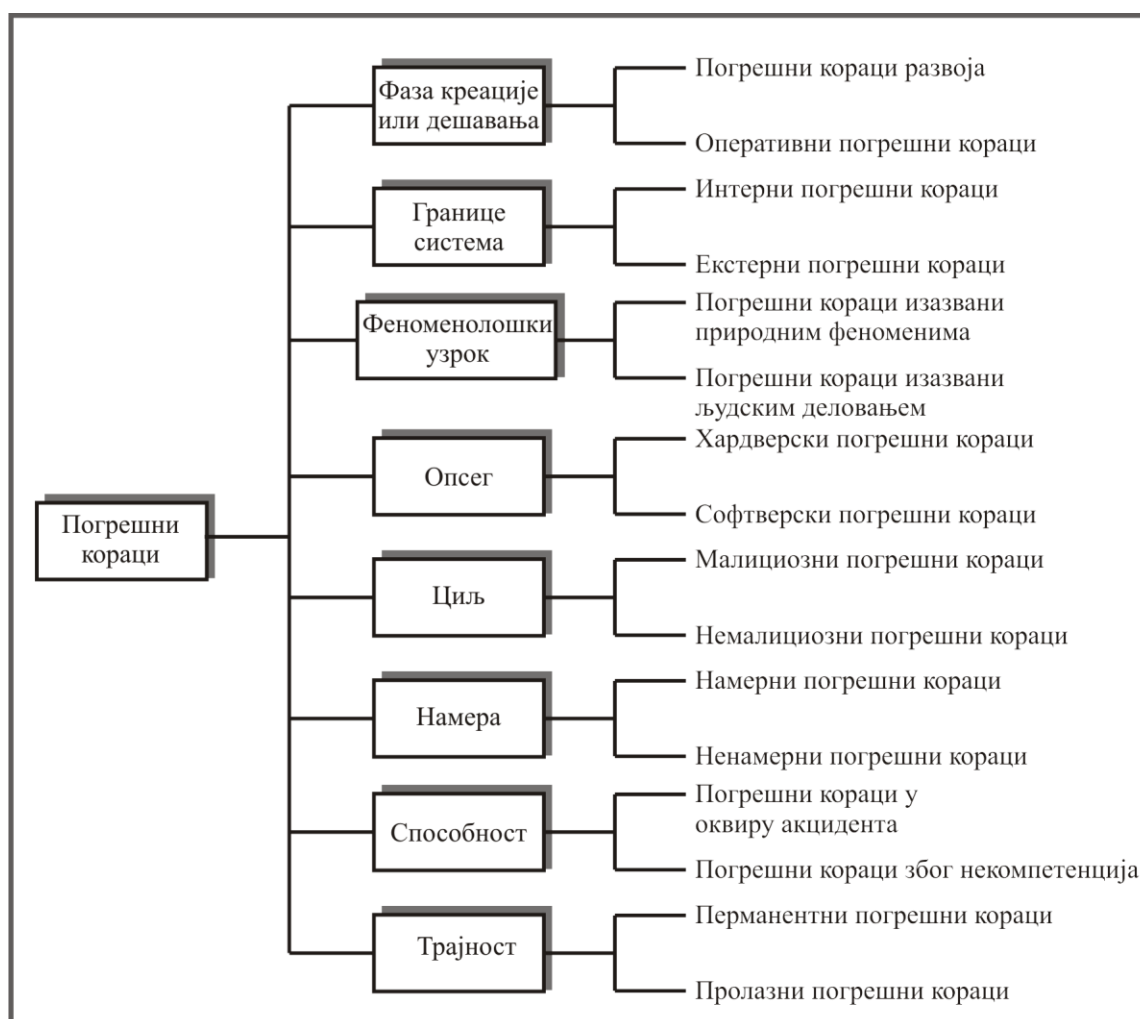
Слика 2.9 – Основна подела погрешних корака, процеса или представа податка у програму (Avižienis et al , 2004)
