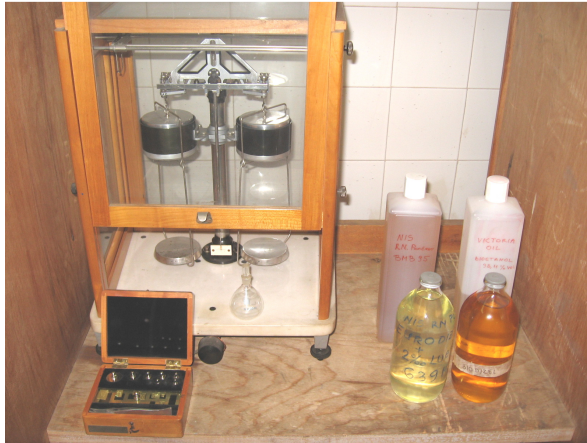
Слика 2.47 Одређивање густине горива пикнометарском методом
