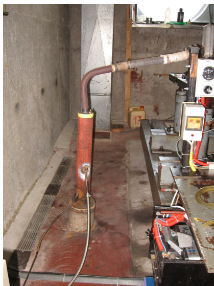
Слика 3.20 Издувни систем са сондама за узорковање изд. гасова
