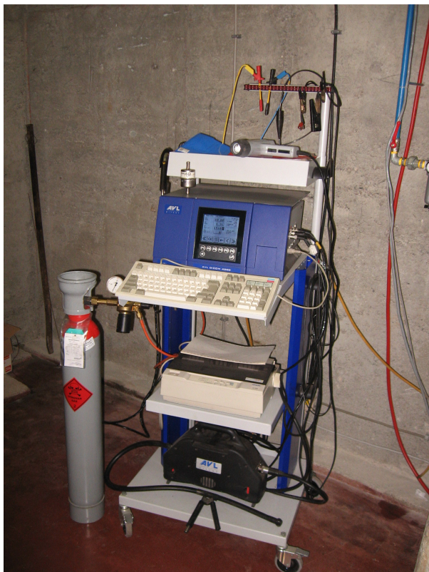
Слика 3.22 Анализатор гасова AVL DiCom 4000 током калибрације
