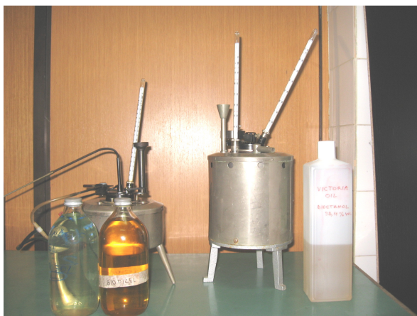
Слика 2.49 Одређивање тачке паљења по методама: Пенски-Мартенс (лево), Абел-Пенски ( десно)
