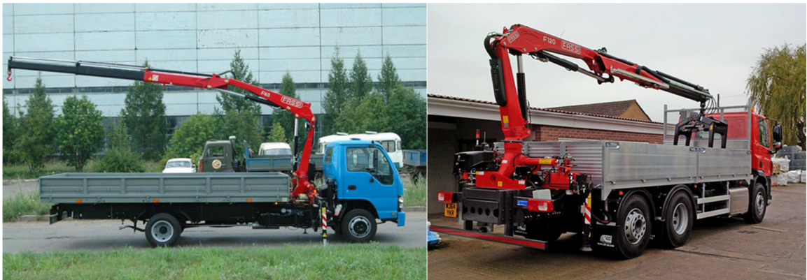
Слика 3.7 Варијанте уградње зглобне стреле – испред и позади товарног простора
