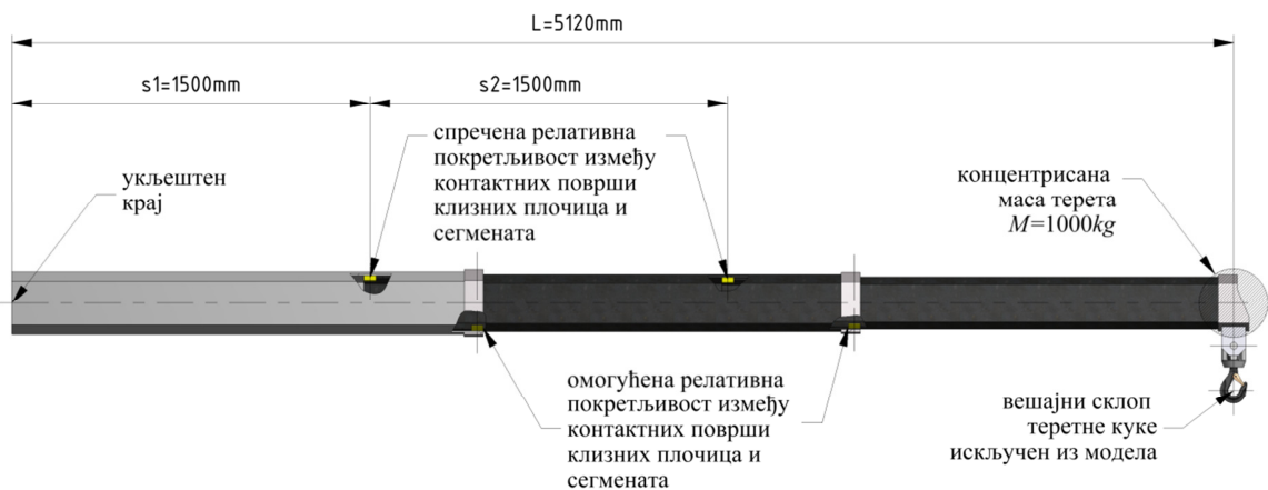
Слика 6.5 Гранични и контактни услови коначно-елементног модела на примеру конкретног случаја испитивања за s_1=1500 \text{ mm} , s_2=1500 \text{ mm} и M=1000 \text{ kg}
