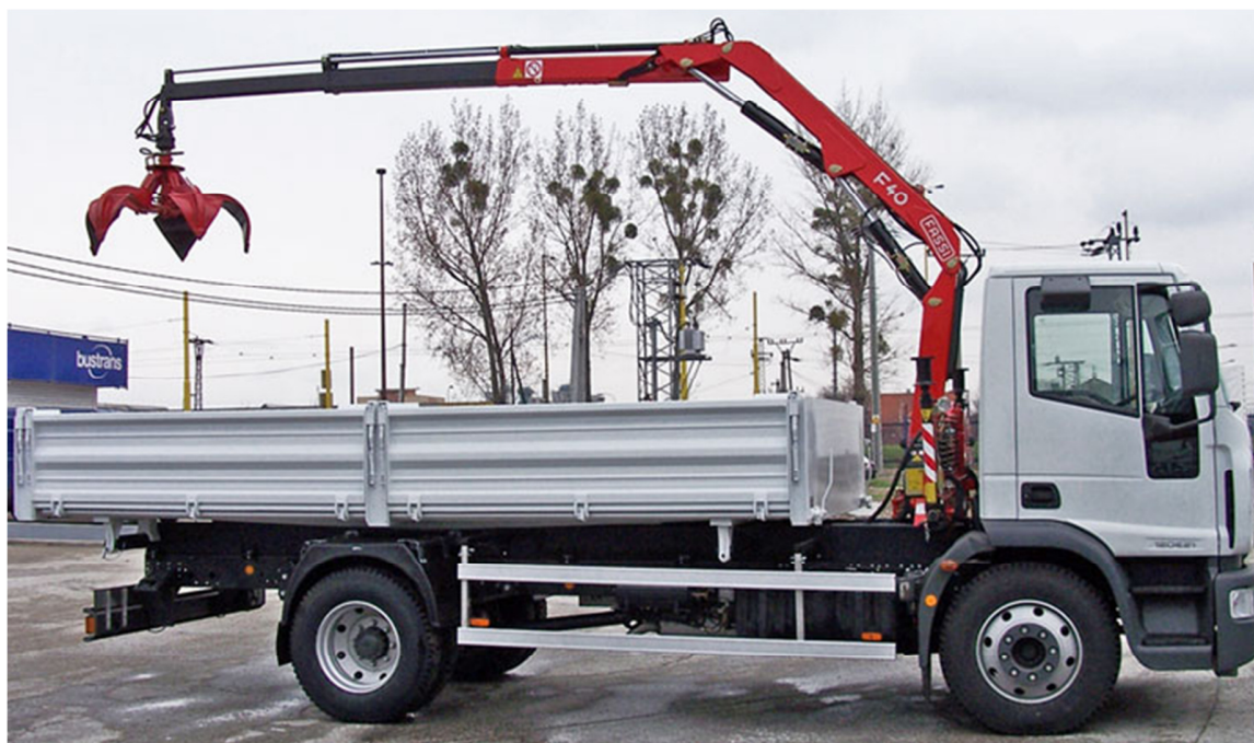
Слика 3.1 Камион као вучно возило са монтираном зглобном стрелом за манипулисање теретом
