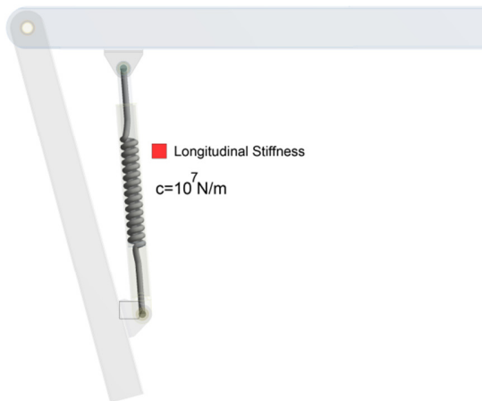
Слика 5.15 Еластична карактеристика хидроцилиндра
