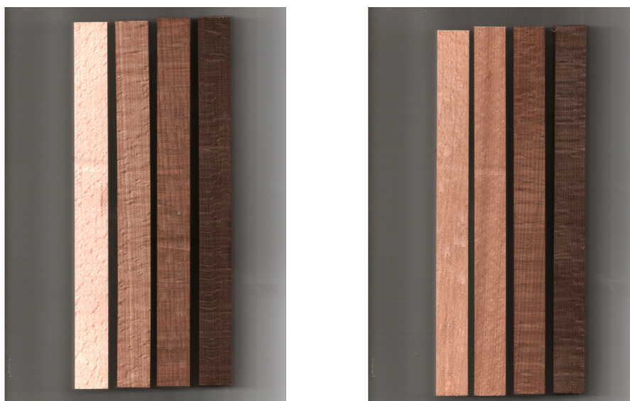
Slika 23. Epruvete beljike (levo) i lažne srčevine (desno) pre i posle tretmana (s leva na desno: netretirani, termički tretirani na 170°C, 190°C i 210°C – 4h).
