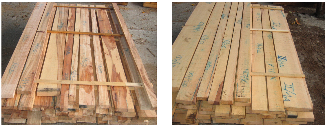
Slika 20. Izrezane radijalne daske iz područja lažne srčevine (levo) i beljike (desno) pripremljene za proces veštačkog sušenja
