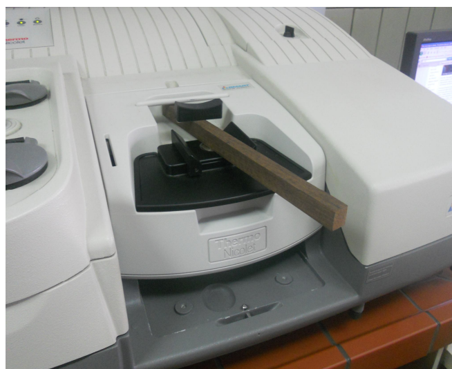
Slika 31. Način snimanja NIR spektara sa radijalne površine termički modifikovanog bukovog drveta
