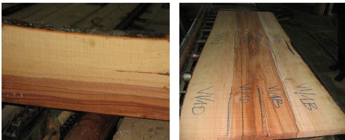
Slika 19. Izrezana bukova radijalna daska sa lažnom srčevinom iz dela A ili C (levo) i iz pravca B-D (desno)
