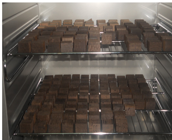
Slika 25. Uzorci za ispitivanje fizičkih svojstava drveta
