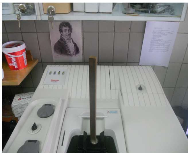
Slika 30. Način snimanja NIR spektara sa poprečne površine termički modifikovanog bukovog drveta
