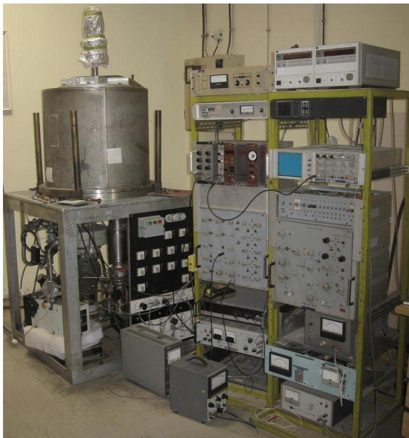
Слика 11. Електронски спектрометар_ЕСМА
