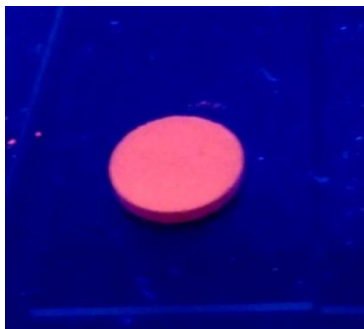
Slika 6.13 Fosfor \text{GdVO}_4:\text{Eu}^{3+} pod ultraljubičastim svetlom u obliku tablete korišćen za merenje luminescencije u funkciji temperature
