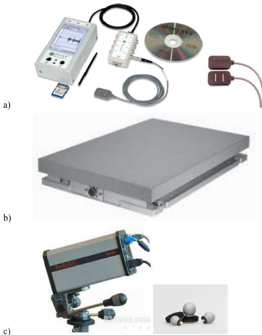
Slika 10. Prikaz aparatura koje su korišćene za akviziciju rezultata: a) telemetrijski sistem za praćenje elektromiografskih varijabli; b) platforma sile za praćenje dinamičkih varijabli, c) sistem infracrvenih kamera za praćenje kinematičkih varijabli.
