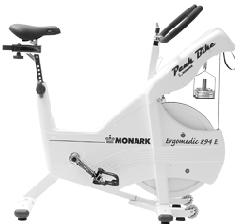
Slika 5. Prikaz bicikl ergometra (Monark 894E, Varberg, Sweden) korišćenog za procenu snage u testu VAnT 6s .
